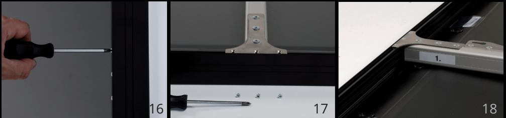
Mittelstützen werden an den bereits vormontierten Klemmleisten befestigt. Lösen sie dazu die Schrauben, setzen Sie die Mittelstütze entsprechend der Abbildungen in den DecoFrame ein und sichern Sie diese wieder mit den drei Senkkopfschrauben.
