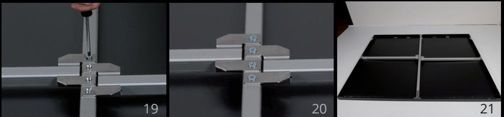
Querstreben werden am Rahmenprofil an den bereits vormontierten Klemmleisten und an den Mittelstützen mit Senkkopfschrauben an den M6 Gewindeeinsätzen befestigt.
