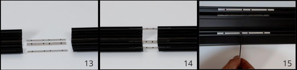
Im Falle von geteilten Profilen werden diese mit Klemmleisten verschraubt. Schieben Sie dazu die Klemmleisten je zur Hälfte in die dafür vorgesehenen Nutkanäle der zu verbindenden Rahmenelemente. Schieben Sie die Profile spaltfrei zusammen und fixieren Sie die Verbindung mit dem mitgelieferten Sechskantschlüssel an den Gewindestiften.
